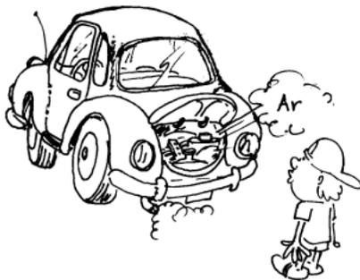
Sistemas de refrigeração de motores de veículos como o fusca ou de muitas motocicletas utilizam o ar como substância refrigerante.
