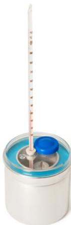
Figura 5.3: Tipo de calorímetro que pode ser usado no experimento (<https://www.istockphoto.com/mx/foto/calor>)
