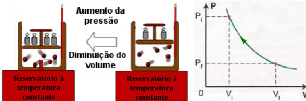
Figura 8.8: Compressão isotérmica (Fonte: <https://www.manualdaquimica.com/quimica-geral/transformacao-isotermica-ou-lei-boyle.htm> - modificada)
