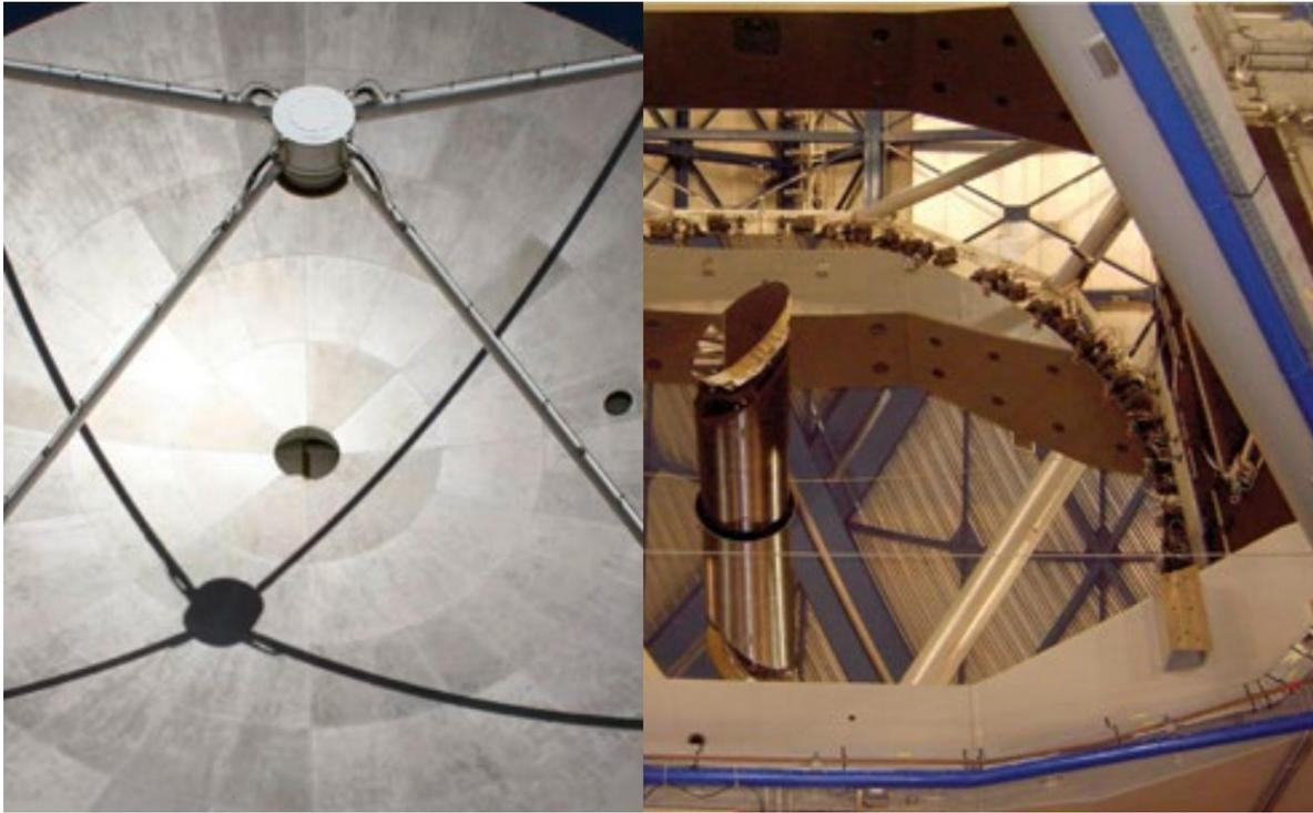
**Figura 6:** Detalhe do prato da antena do ALMA (esquerda) e o espelho primário de um dos telescópios ópticos do VLT (esquerda). Créditos: ALMA (ESO/NAOJ/NRAO (esquerda), Pablo A. Torres (direita))
